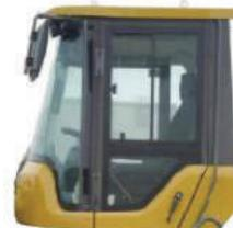
Cabina de estructura esquelética cerrada integrada que tiene una gran visión, equipada con aire acondicionado y asiento con suspensión mecánica de respaldo alto, que hace que el operador se sienta más cómodo.
