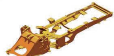
Nuevos bastidores delantero y trasero reforzados con la estructura articulada compuesta patentada pasó millones de veces por pruebas experimentales de fatiga, 1,000 horas de prueba experimental intensiva y 5,000 horas de prueba en el lugar de trabajo, alcanzando una capacidad de carga útil super fuerte.
